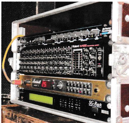
Im Rack Setup eine kleine Überraschung: Das Signal aus der C-3 geht zunächst in die Marshall JMP-1-an. Hinter der Marshall wird das Signal mit einem Mic-Preamp verstärkt, um die Leslies mit hohem Pegel anzufahren. Ansonsten befinden sich im Rack der Rackmixer und ein Korg SG-Rack Piano-Expander.
